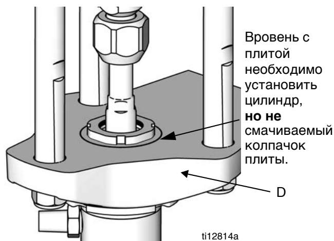
Рис. 32. Произведите выравнивание цилиндра и крепежной плиты.
